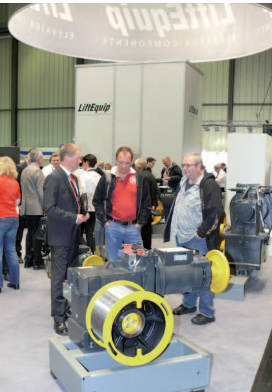
Der neue Trommelantrieb mit TW130 für Aufzüge ohne Gegengewicht stieß auf breites Interesse
