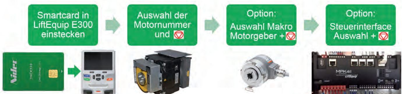
Bild 11: Inbetriebnahme und Parametrierung
