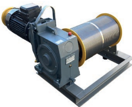
Bild 7: Getriebe TW63 horizontal mit Trommel und Treibscheibe mit Außenlager auf Rahmen
